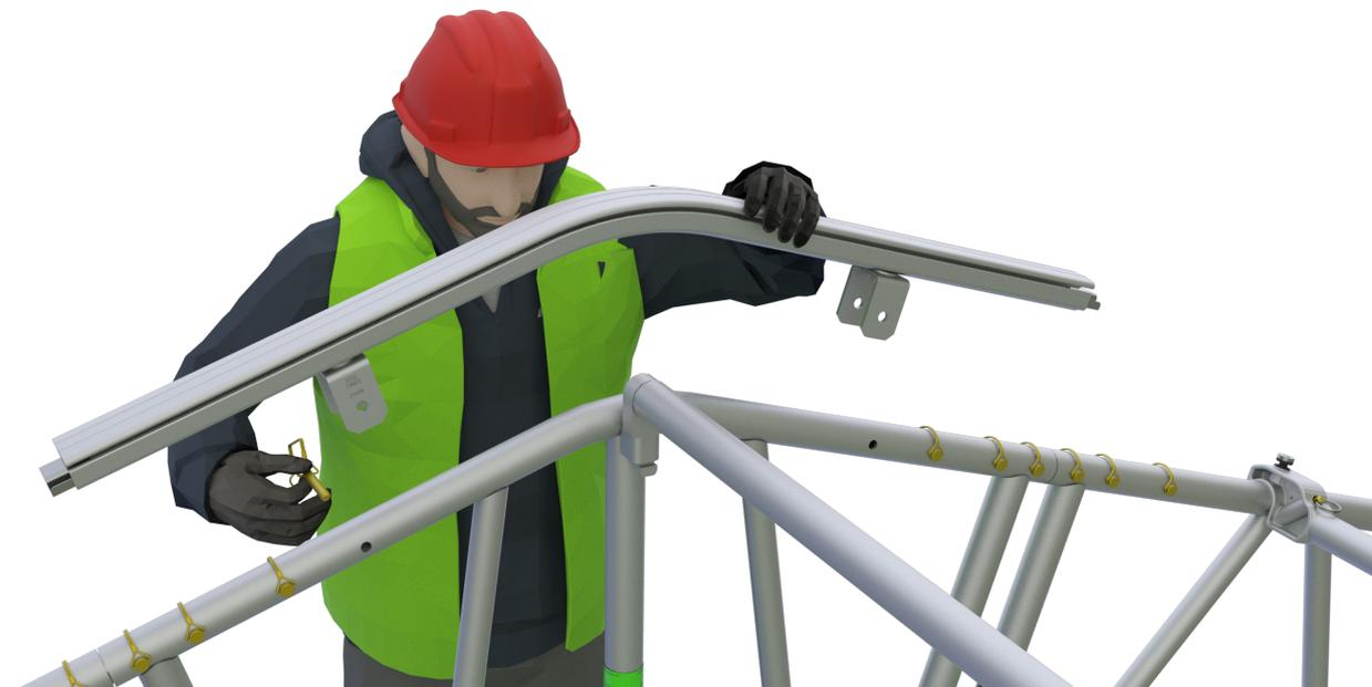
Mettez en place le rail faîtière, en le fixant à l'aide de deux chevilles à détachement rapide AF0002 (voir l'illustration ci-dessus).
