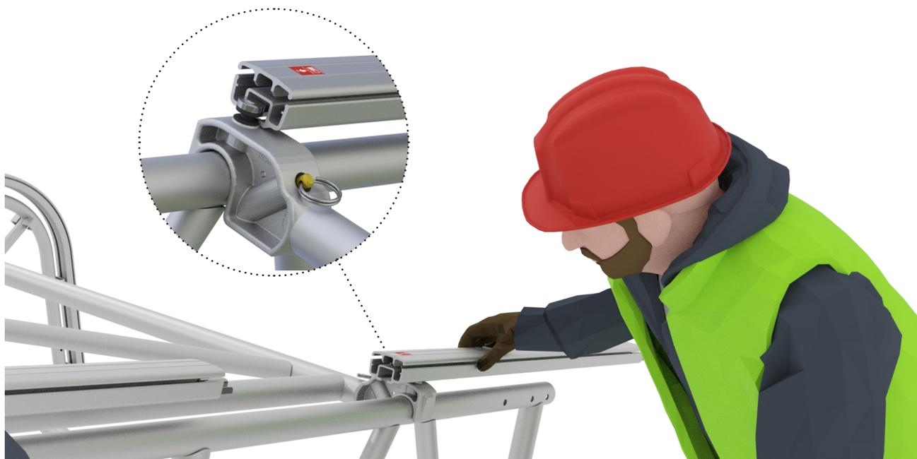
Glissez le rail DeepFlow™ correspondant en haut sur la pente dans l'axe de la poutre, l'ergot étant tourné vers le bas avec l'étiquette sur le dessus, en vous assurant que le rail s'engage avec les écrous bombés fixés sur les griffes de l'entretoisement.
