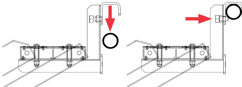
Utiliser des supports RBO011 et RBO012 pour fixer le DESSA RANGER™ Stair sur des tubes d'échafaudage de 48,3mm. Les supports peuvent être immobilisés avec la fixation intégrée à boulons permettant d'empêcher le moindre soulèvement.
