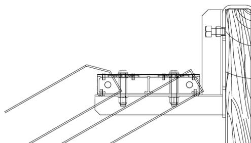
Utiliser également les supports RBO011 et RBO012 avec des solives en bois mesurant jusqu'à 50 mm de large. On peut utiliser le boulon anti-soulèvement pour fixer l'escalier en serrant légèrement sur la solive en bois.
