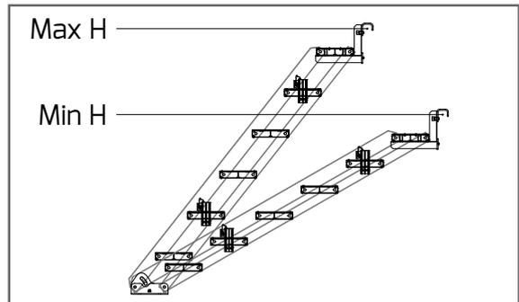
Nota: le tableau ci-dessus se rapporte à une plage d'applications comportant l'utilisation de supports de connecteur de tube RBO011 et RBO012 seulement. La hauteur se mesure du centre du tube d'échafaudage dans lequel le support de connecteur s'engage.
