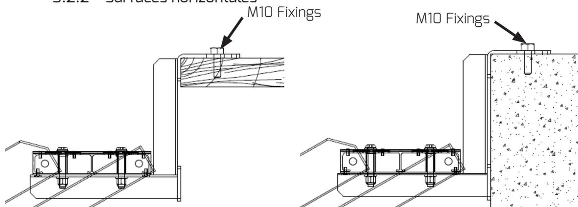
Pour les surfaces horizontales, utiliser des supports RBO021 et RBO022 avec des fixations M10.
