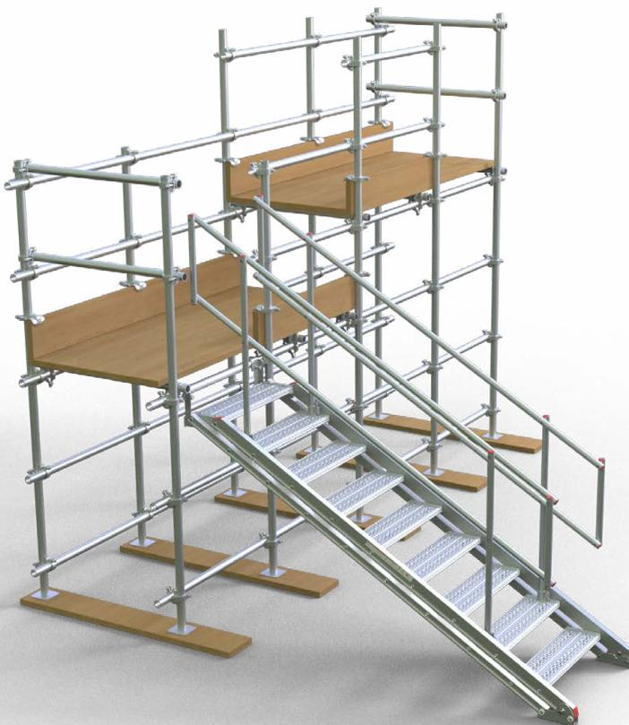
Fase n. 4 – Bloccare la scala ingaggiando il dado di blocco nel palchetto inferiore. Utilizzare un cacciavite standard per impalcature.
